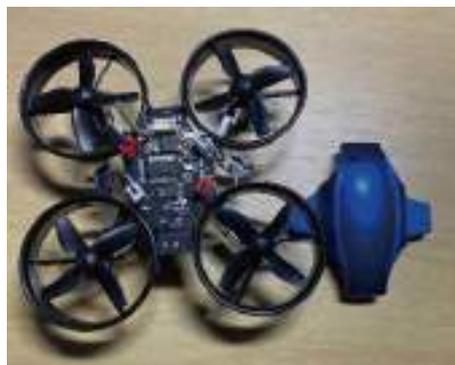
写真1：製作中の小型ドローン
