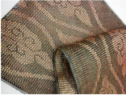
CFRP糸を用いた織物
